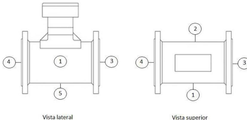
Critério de avaliação: Aprovado se o medidor apresentar espessura média mínima de 70 µm em quaisquer pontos de ensaio e medição; Reprovado se o medidor apresentar espessuras inferiores a 60µm em quaisquer pontos de ensaio e medição; Aprovado com comentário se em quaisquer pontos de ensaio e medição apresentar espessuras superiores a 240µm.
